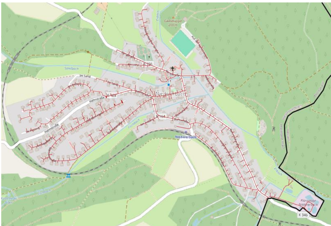
Abbildung 5-7 Aufbau eines warmen Nahwärmenetzes (Variante 1); Ortsgemeinde Niedererbach (Quelle: SLP, veränderte Darstellung)
