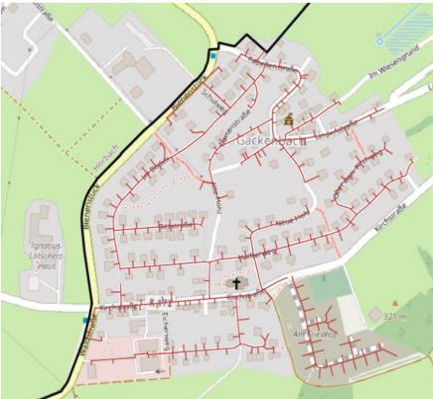
**Abbildung 5-9 Aufbau eines warmen Nahwärmenetzes (Variante 1) – Kernort; Ortsgemeinde Gackebach, veränderte Darstellung (SLP).**
