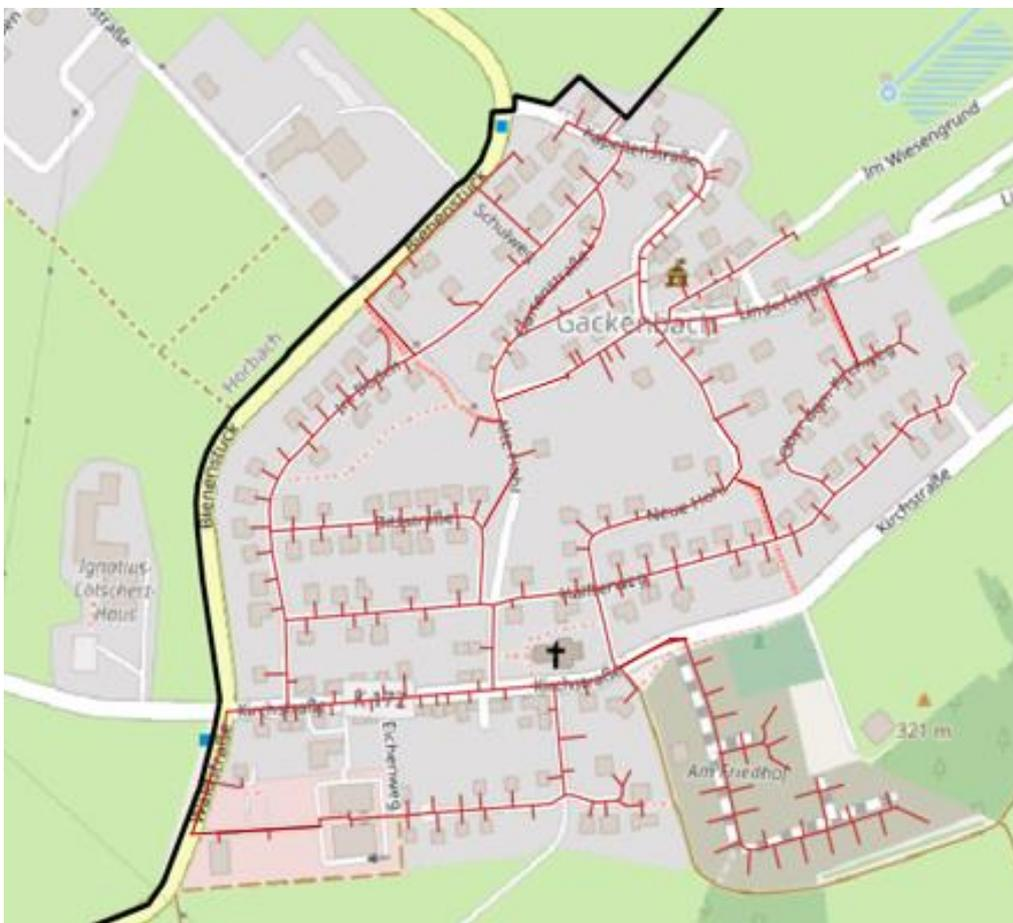
**Abbildung 5-10 Aufbau eines kalten Nahwärmenetzes (Variante 2a/2b) – Kernort; Ortsge-
